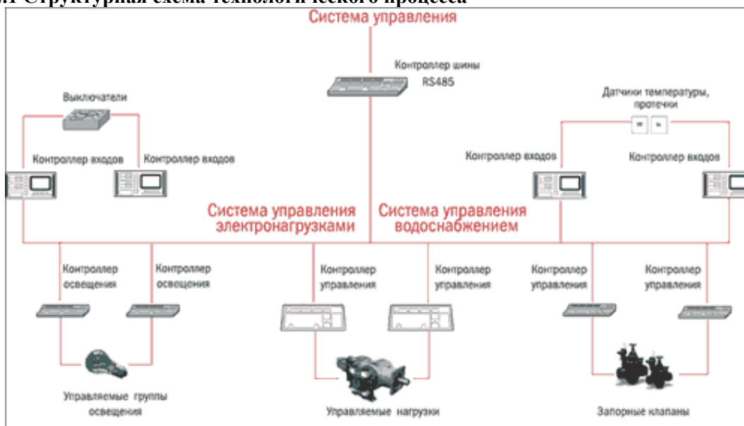
Рисунок 1 – структурная схема системы «Умный дом»
