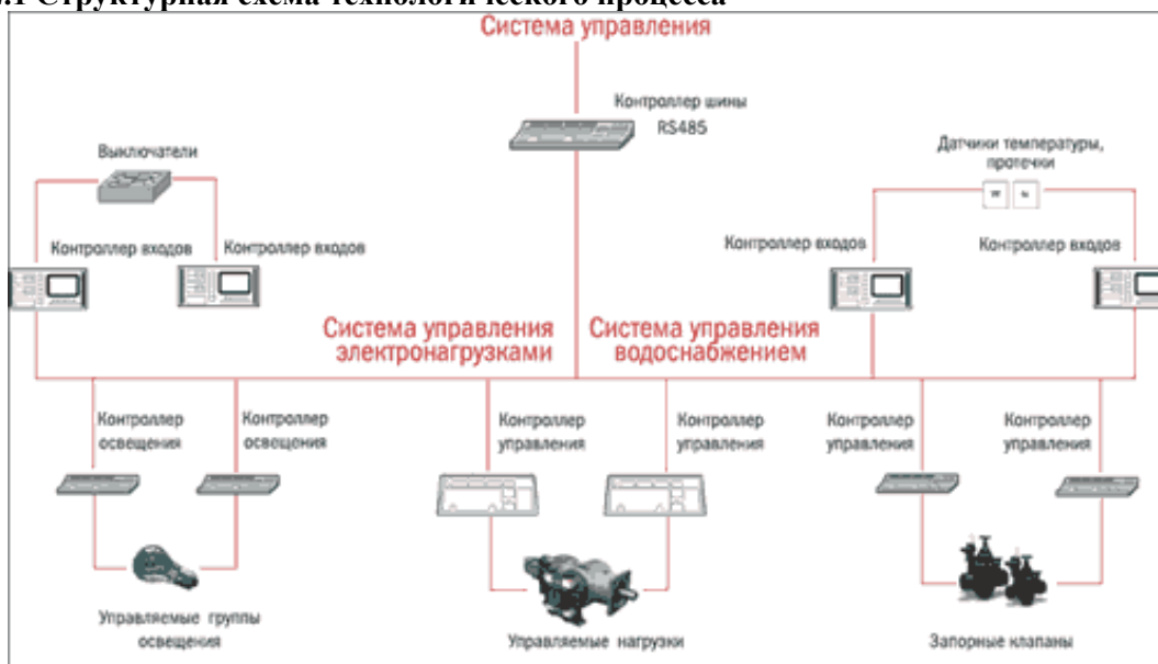
Рисунок 1 – структурная схема системы «Умный дом»
