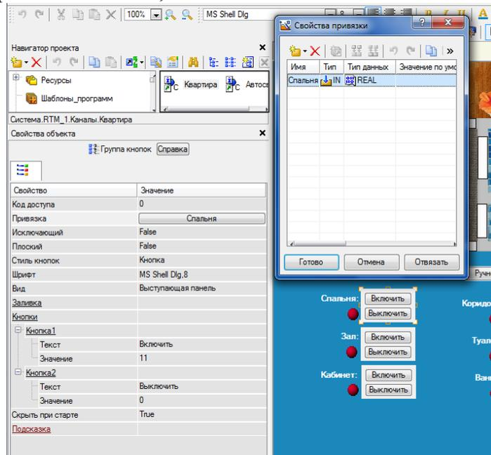
Рисунок 9 – Редактирование кнопок
