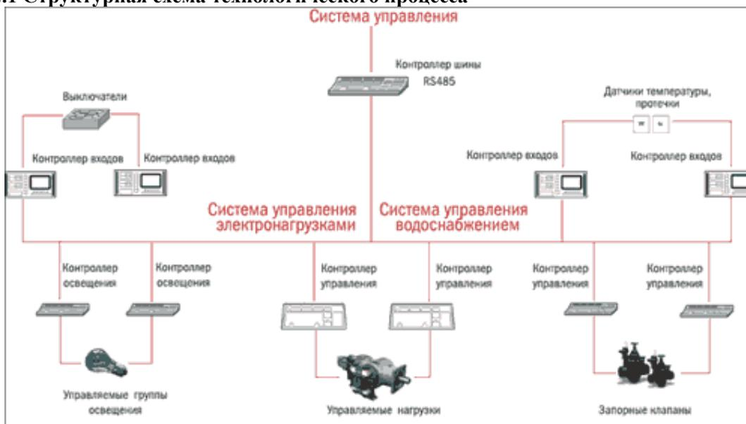
Рисунок 1 – структурная схема системы «Умный дом»
