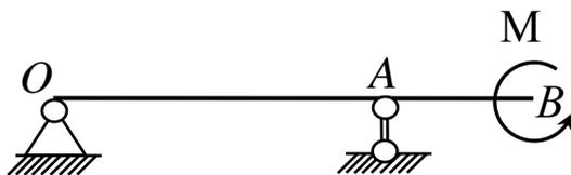
Балка нагружена парой сил в вертикальной плоскости балки с моментом, величина  $M$  которого равна  $8$  Н·м и приложенным на конце  $B$  балки. Определить величины реакций опоры, приложенной в точке  $A$  балки.
