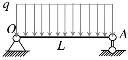
На участке  $OA$  балка нагружена вертикальной распределенной силой с интенсивностью  $q$ , равной  $8$  Н/м. Определить величины реакций опоры, приложенной в точке  $A$  балки.
