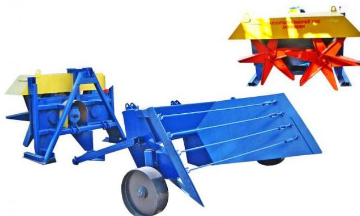
Рис. 2. Общий вид разбрасывателя органических удобрений РУН-15
