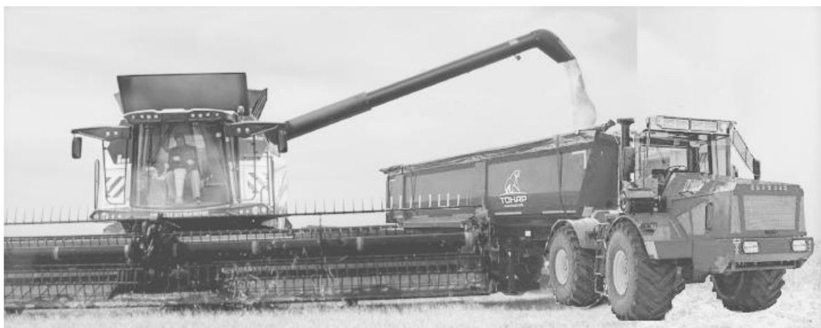
Рис. 1. Принцип работы транспортного агрегата с оборотным полуприцепом (зерновозом)
