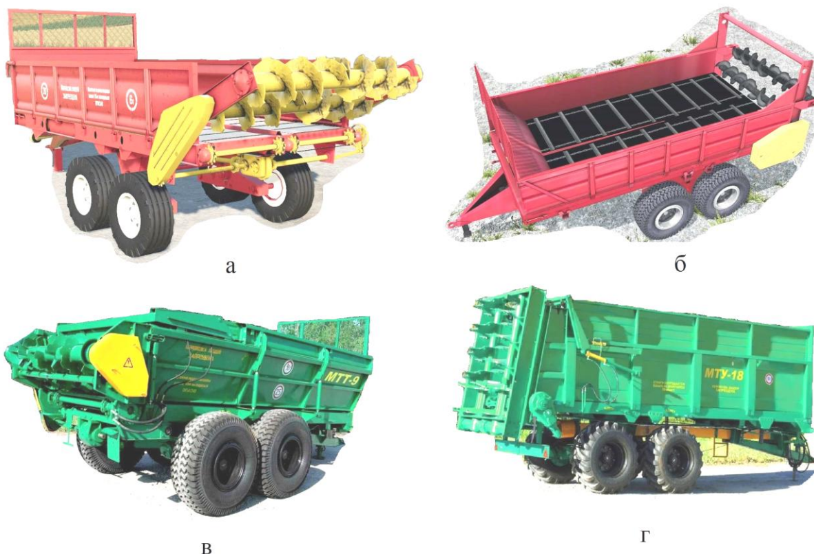
Рис. 1. Общий вид разбрасывателей органических удобрений: а – РОУ-6; б – ПРТ-10; в – МТТ-9; г – МТУ-18.
