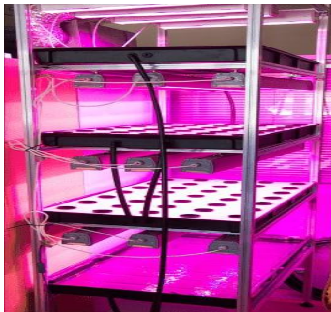
Рис.2. Экспериментальная гидропонная установка с системой капельного полива
