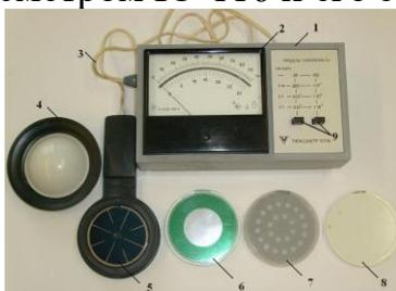
Рис.1.3. Общий вид люксметра типа Ю-116: 1-корпус прибора, 2-измерительная шкала, 3-соединительный шнур, 4-рассеиватель, 5-активный фотоэлемент (датчик), 6-8-калибровочные насадки диапазонов измерения с коэффициентами масштабирования: 6- 1:10, 7- 1:100, 8- 1:1000, 9 переключатель диапазонов измерения для соответствующих калибровочных насадок.
