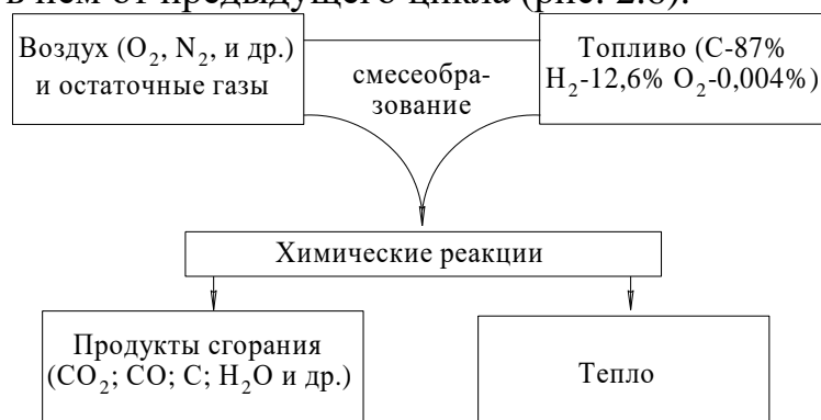
Рис. 2.6. Схематическое изображение процессов смесеобразования и сгорания
